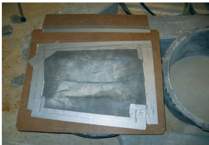
Figuur 3. Prototype deksel met rubberen afdichting
