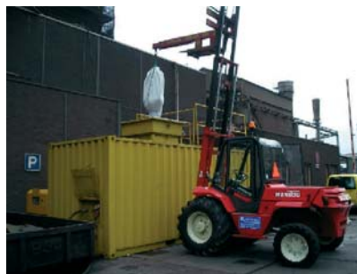
Figuur 3. Big Bag, overstort met heftruck en uitstroom uit Big Bag
